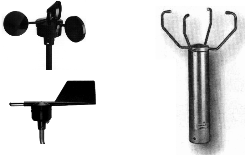
Şekil 2. Kap anemometre, jirüet (rüzgar yönü ölçer) ve ultrasonik anemometre.
