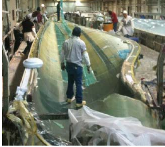
Resim 12. İnfüzyonu Bitirilmiş Bir Kanat Yüzeyinden Görüntü
