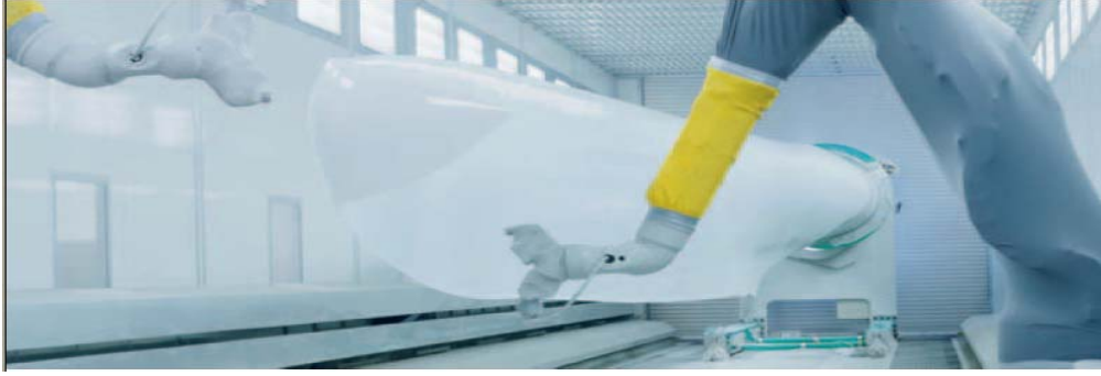
Resim 16. Robot Kollar İle Kanat Yüzeyine Boya Uygulanması
