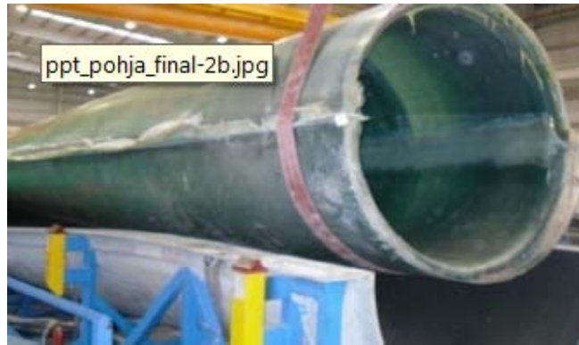
Resim 14. Kanadın Kalıptan Kaldırılması
