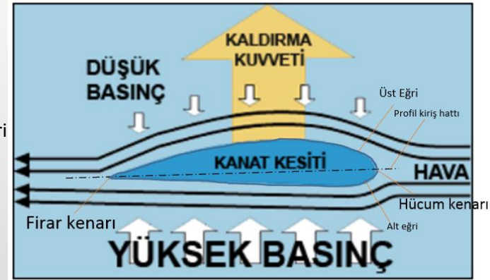
Şekil 3. Kanadı oluşturan kesit profilleri ve kaldırma kuvvetinin oluşumu
