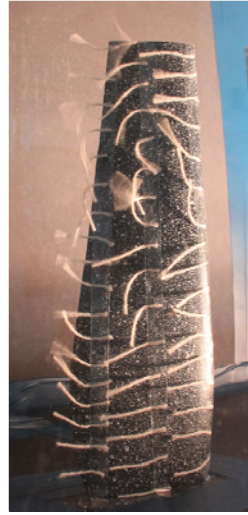
Şekil.14 Kısa iplerle yapılan iplikçik deneyi
