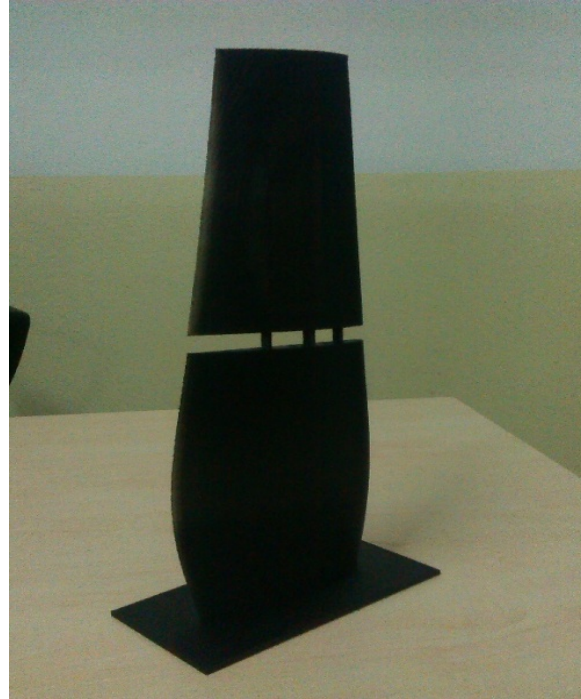
Şekil 6. 3D yazıcıda üretilmiş kanat.
