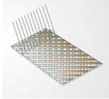
BIAXIAL ELYAF: ÇİFT YÖNLÜ ELYAF \pm 45^\circ
