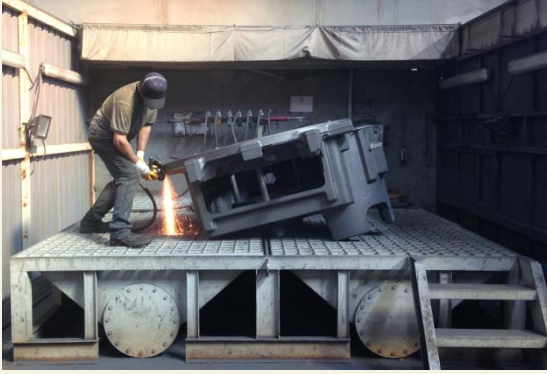
Basıncılı Hava ile çalışılan 15 Adet Manuel Taşlama İstasyonu
