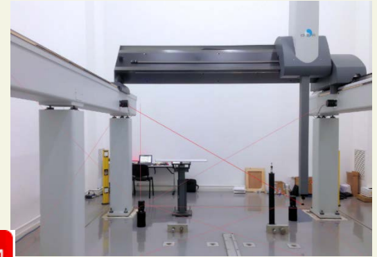
DEA CMM 3 Boyutlu Ölçüm Sistemi
