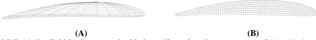
Şekil 7. (a) Konik kiriş elemanın kesitinde üretilen eşlenmiş çözüm ağı ve (b) konik olmayan kiriş elemanın kesitinde oluşturulan serbest çözüm ağı
