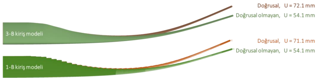
Şekil 9. Yüksek mertebeli 3-B ve indirgenmiş mertebeli 1-B SE modellerinin geometrik olarak doğrusal ve doğrusal olmayan deforme olmuş şekilleri (ölçek faktörü = 2.5)
