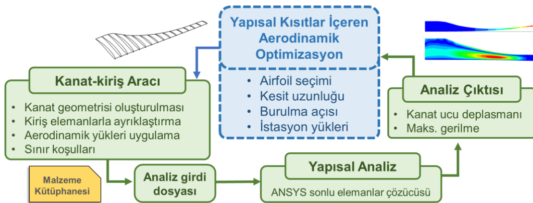
Şekil 11. Kiriş-kanat modelleyicisi/çözücüsünün akış şeması
