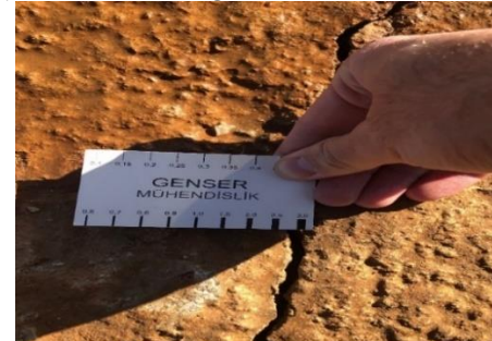
Şekil 19. (a) 2 mm Genişlikli Çatlak (b) 3 mm Genişlikli Çatlak
