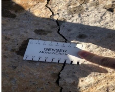
Şekil 19. (a) 2 mm Genişlikli Çatlak (b) 3 mm Genişlikli Çatlak
